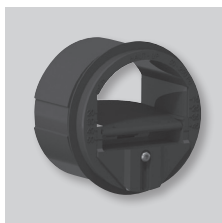
RDR Automatische volumeregelaar (50-250 Pa) die (gemonteerd in het luchtkanaal) zorgt voor een constant luchtdebiet
