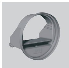
RD BP SM Speciale automatisch geregelde lagedruk-volumeregelaar (20-100 Pa) zonder mof voor directe montage in de mof van het aan- en afzuigventiel (BDOP). Diameter: 80 mm. Luchtdebiet: 15 of 30 m³/h.
